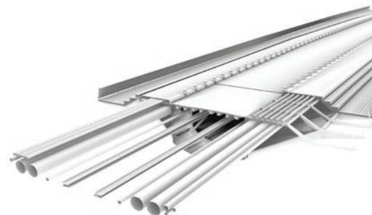
*Le tablier, sur la structure caisson*
