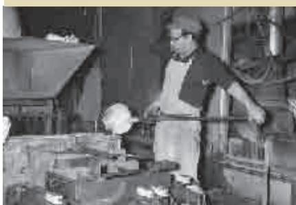
Coulée des culasses dans les moules coquilles métalliques en 1969. Dpt 60, fonderie d'aluminium. © Renault Communication DR.
