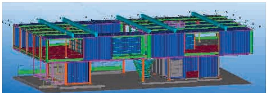
Axonométrie du pavillon montrant les conteneurs de l'étage positionnés en porte-à-faux et les cinq poutres transversales posées en toiture pour renforcer la structure (image CFAO : bureau d'études Loison). © Loison S.A.S. / Manh Architectures Nancy
