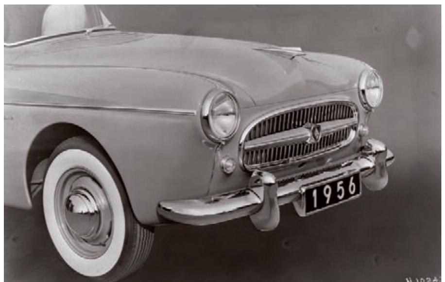
Dpt. 32 Traitements électrolytiques : sur la Frégate Amiral 1956 le chrome est omniprésent, des pare-chocs à la poignée d'ouverture du capot, en passant par enjoliveurs de roues, les enjoliveurs de phares, les baguettes d'ailes et l'immense calandre à l'américaine.
