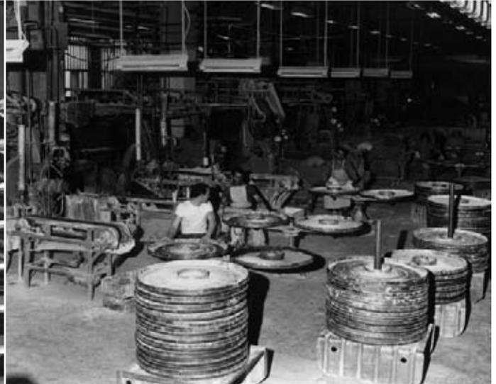
Dpt. 19 Cahoutchouc : éléments de moules de pneumatiques.
